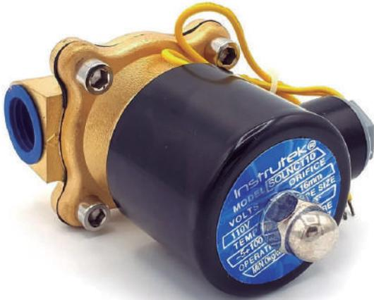
La válvula solenoide, también conocida como electro-válvula, es una válvula automática que sirve para eliminar la necesidad de que una persona opere la válvula manualmente. Los solenoides operan usando una bobina de solenoide electromagnética para cambiar el estado de una válvula de abierta a cerrada, o viceversa. Si la válvula solenoide está “normalmente cerrada”, cuando la bobina está energizada, la válvula se abre por la fuerza electromagnética producida por la bobina.
